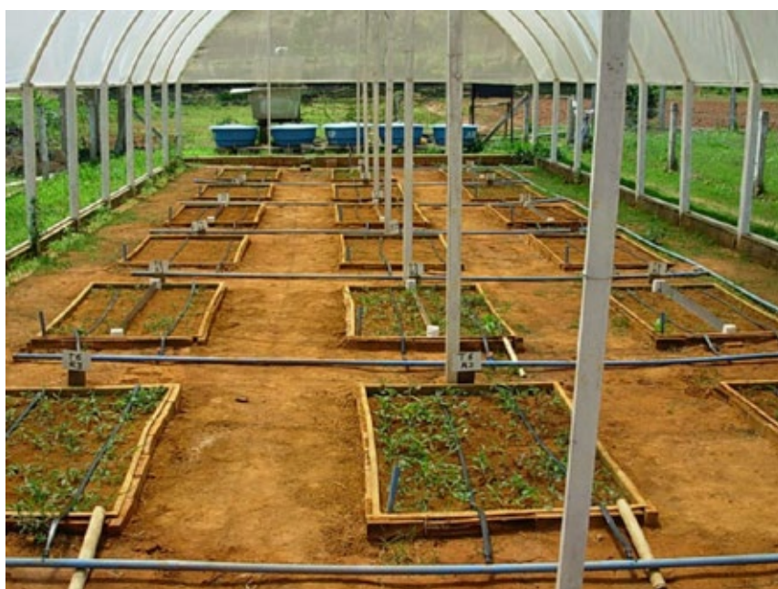
Figura 1: Lisímetros de drenagem instalados na área experimental de Irrigação e Drenagem da Universidade Federal de Viçosa para investigar a variação temporal do efluxo de \text{CO}_2 do solo em áreas de pastagem.
